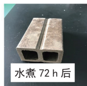
无翘曲变形、无鼓泡、无裂纹 60 d吸水率不到20%，远低于木材发霉吸水率30%
